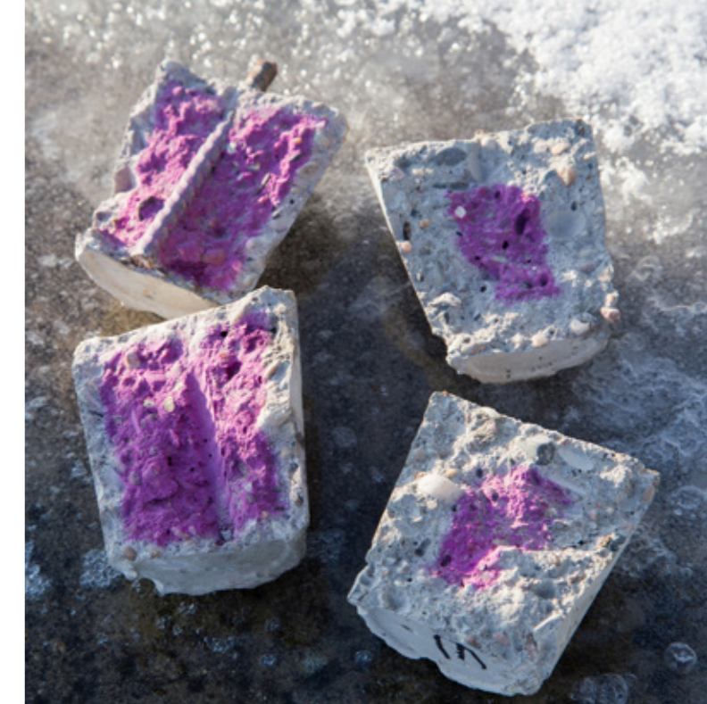
Der pH-Wert von Beton, sichtbar gemacht mit Phenolphthaleinlösung
