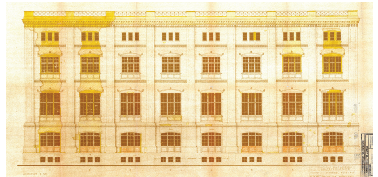
Ansicht Schinkelplatz mit Eintragung der auszubessernden Kriegsschäden
